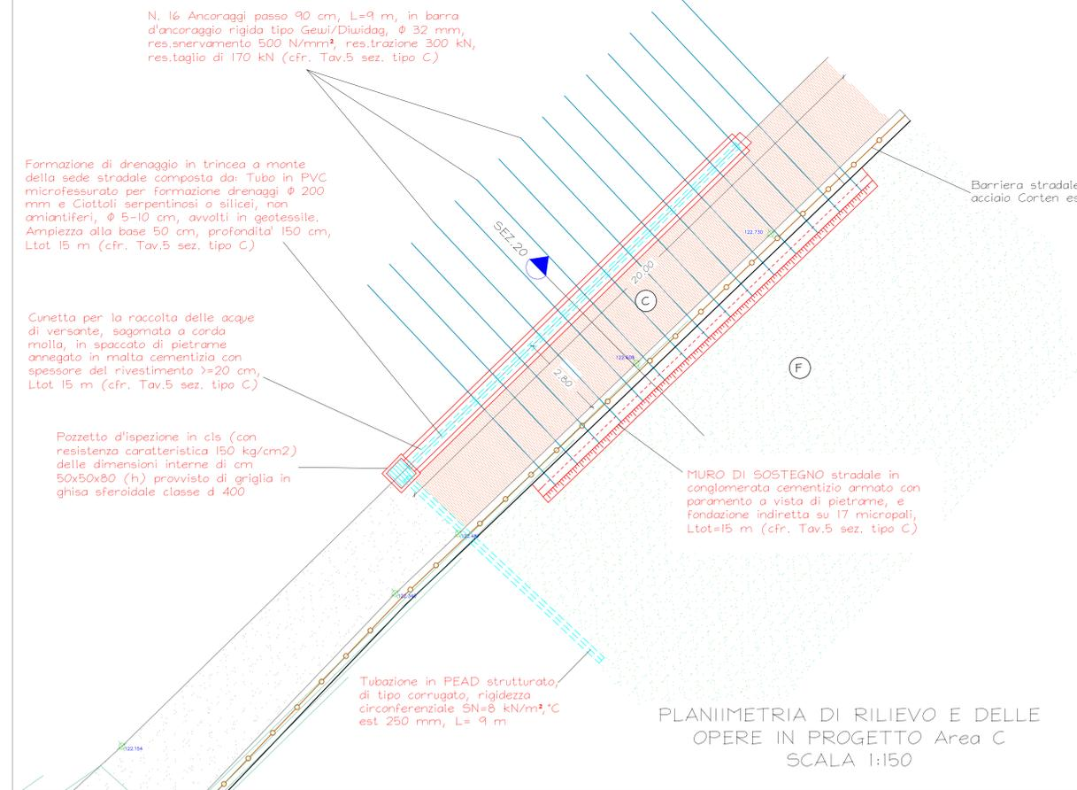
N. 16 Ancoraggi passo 90 cm, L=9 m, in barra d'ancoraggio rigida tipo Gewi/Diuidag,  $\phi$  32 mm, res.snerivamento 500 N/mm<sup>2</sup>, res.trazione 300 kN, res.taglio di 170 kN (cfr. Tav.5 sez. tipo C)
