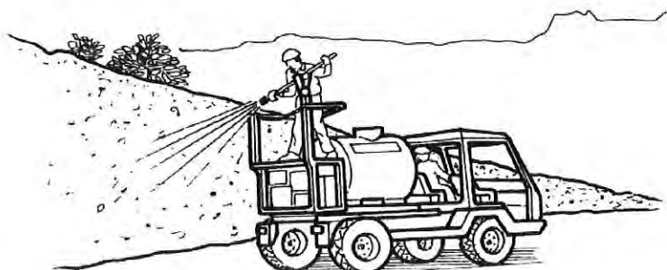
Figura 37 - Inerbimento delle scarpate con idroseminatrice su autocarro 7
