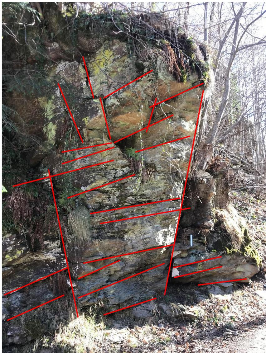
Figura 29 – Affioramento roccioso con rappresentazione delle tracce dei piani di discontinuità (stazione 3)
